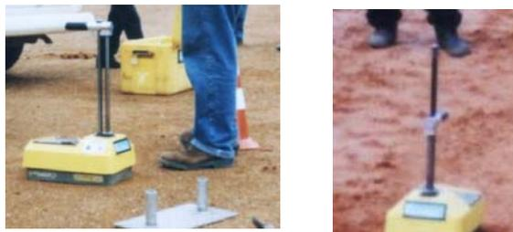
O instrumento é aferido para a água pura e para a areia seca. A variação da umidade é expressa em gráfico correspondente à leitura do contador Geiger. A principal função do aparelho é avaliar a densidade aparente do solo.
