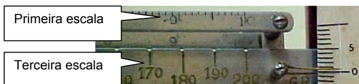
Depois de conferida a primeira escala, verificam-se os eventuais erros nas dez posições possíveis para o cursor da segunda escala. Para isso são colocados os pesos do conjunto padrão e os erros da segunda escala são medidos com auxílio da primeira (que já foi calibrada) e anotadas as correções (positivas ou negativas) a serem feitas para cada posição do segundo cursor.
